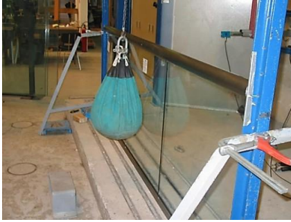
Darbe Dayanım Deneyi / Örnek Görüntü
