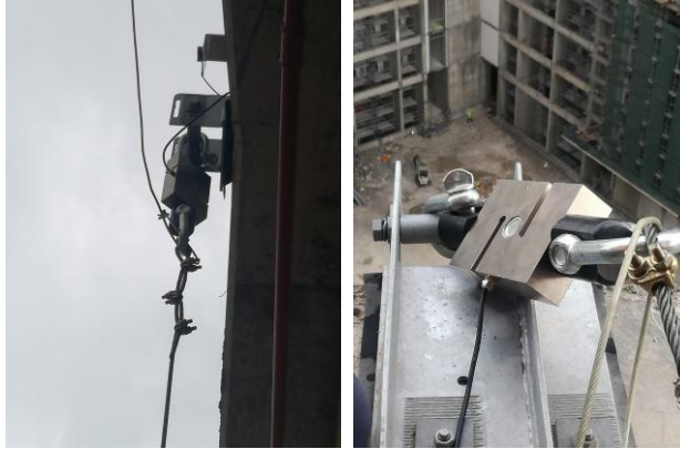
Sahada Ankraj Yükleme Deneyi
