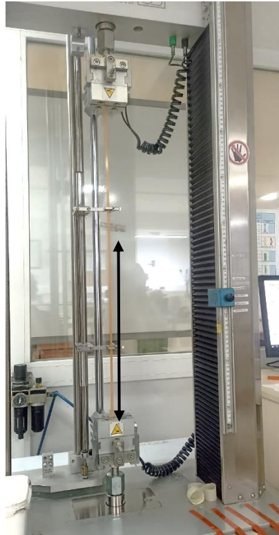
Görsel 2. Kopma anında uzama test görseli
