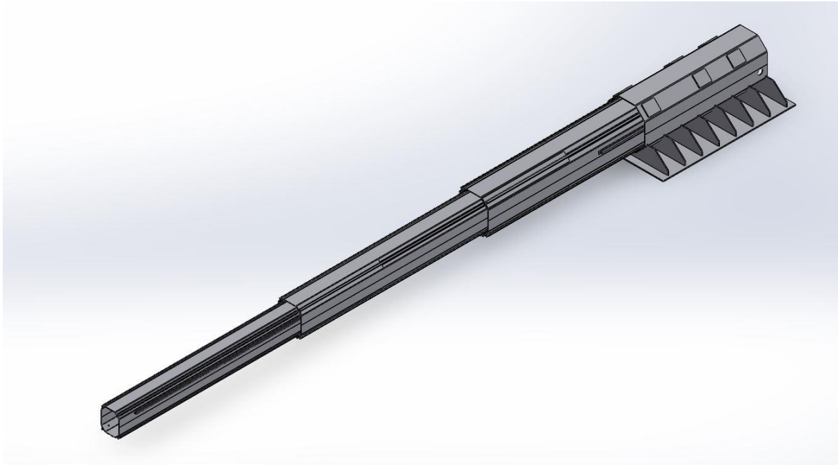
Şekil 6. Teleskobik Yatak Tozaltı Kaynak Sistemi
