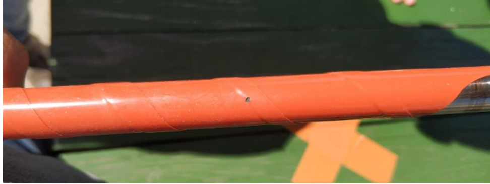
GörSEL 5. Dielektrik delinme dayanımı testi sonrası test parçası
