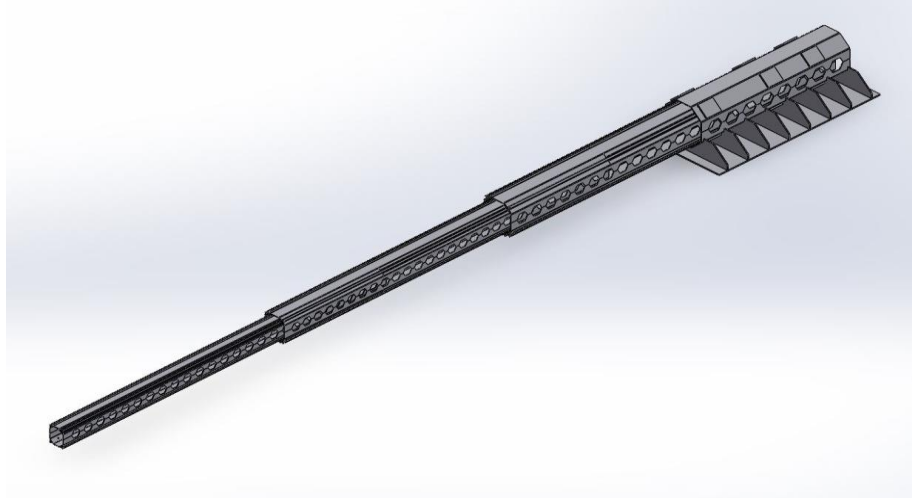
Şekil 23. Ansys R18.2 Optimize Edilmiş Yeni Teleskobik Bom Sistemi
