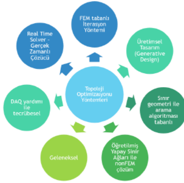
Şekil 2. Topoloji Optimizasyonu Yöntemleri [5]
